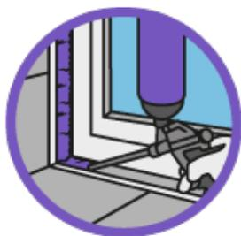
ESPUMA UNIVERSAL PISTOLA se emplea para aislar y sellar marcos, juntas y umbrales de ventanas. Asimismo, se emplea para fijar marcos de puertas de madera, para aislar y llenar huecos y diversas cavidades, tubos y conductos de aire acondicionado, sanitarios, calefacciones e instalaciones eléctricas.
